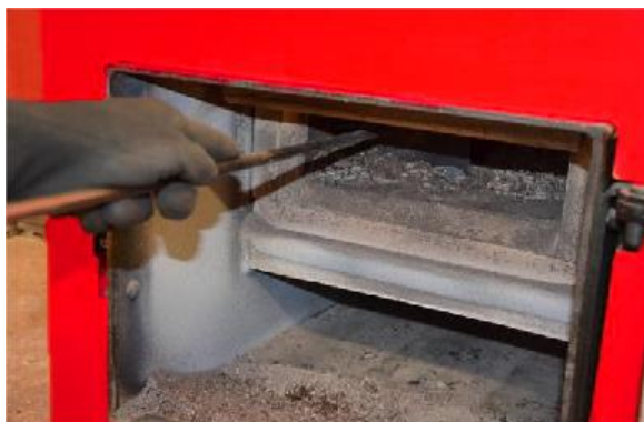
Slika 40: Čiščenje zgorevalne komore
