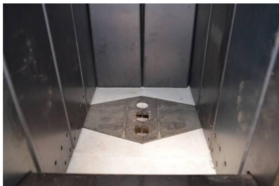
Slika 45: Sevalne lamele v kurišču
